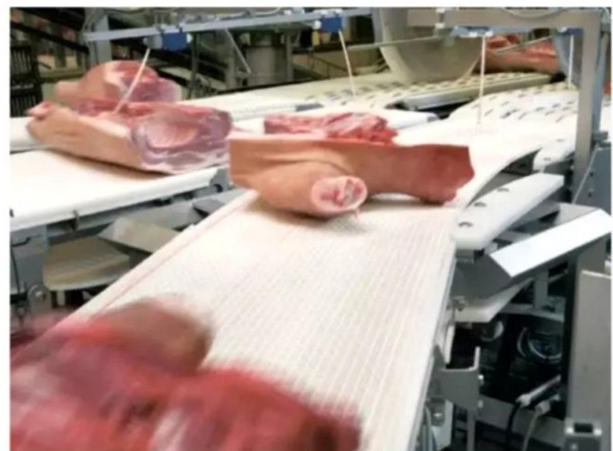
图一 使用了英特诺电动辊筒的肉类传送带
