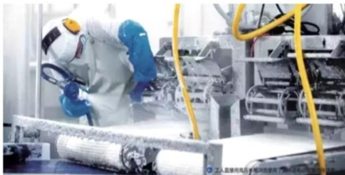
图四 工人直接用高压水枪冲洗使用了英特诺电动辊筒的传送带
