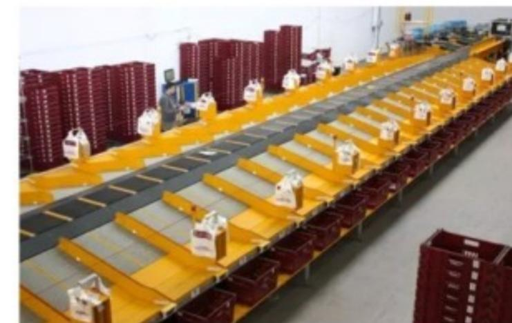
这套系统拥有无与伦比的分拣精度，并具备无缝运行的能力，与此同时，分拣机紧凑的垂直设计也有效减少了空间占用，实现了对Frisco.pl分拣中心的进一步优化。此外，该系统还集成了采用24V微型电动滚筒的输送系统，确保了Frisco.pl的货品采用零压力积放的方式输送到贴标和包装区域。即使在Frisco.pl的季节性高峰期，分拣机也能保持几乎100%的准确率。
