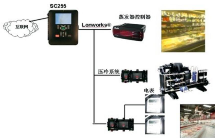
图1 优化电子控制系统拓扑图
