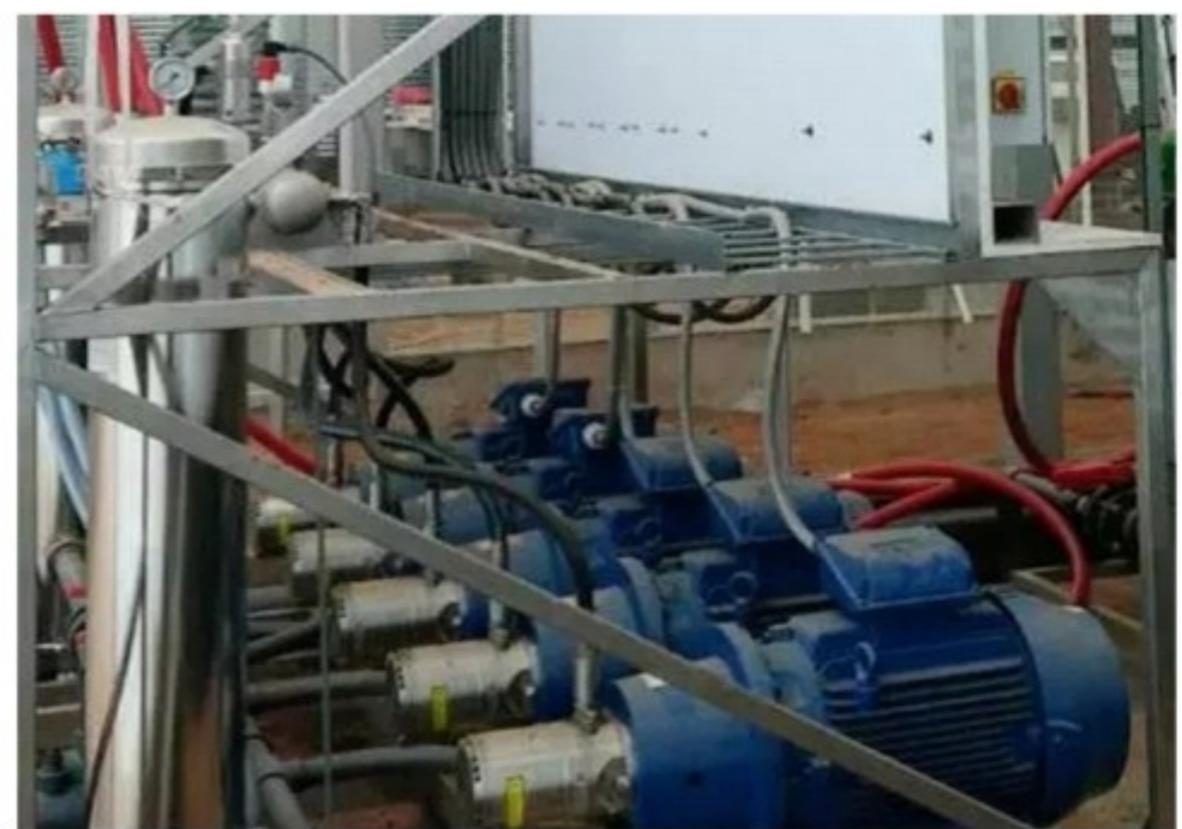
图二 5 台丹佛斯 PAHT90 系列高压泵为喷雾系统提供压力
